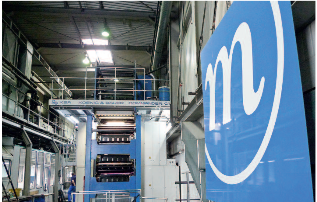
An der Stelle der früheren KBA Journal steht nun eine 32-Seiten Commander CT. Ausgetauscht wurde quasi bei laufendem Betrieb – während die aktuelle Produktion auf der benachbarten Geoman und jeweils einem 16er-Turm der alten bzw. neuen Maschine (mit manchem Vorprodukt) bewältigt werden musste.
